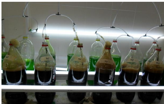
Figura 1. Montaje biorreactores laboratorio
