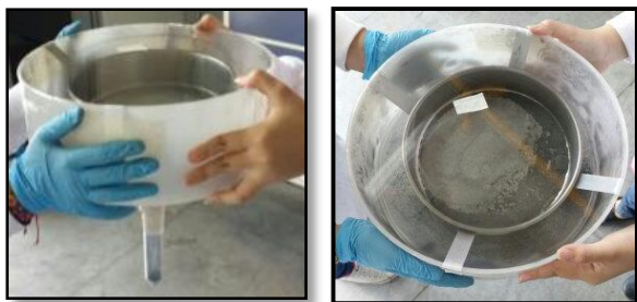
Figura 4. Imágenes del montaje para tamizado del grafito con el fin de impedir presencia del material particulado en el aire, ya que estas partículas afectan la vía aérea.
