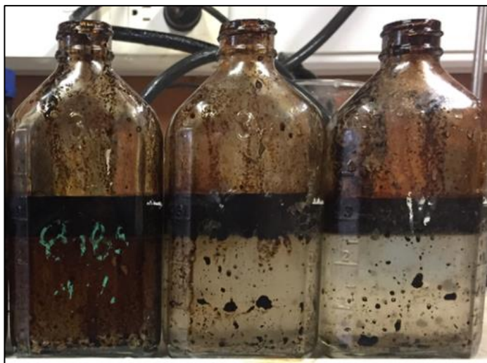
Figura 12. Inspección visual prueba compatibilidad fluido-fluido (30% Fluido – 70% Tratamiento Químico)
