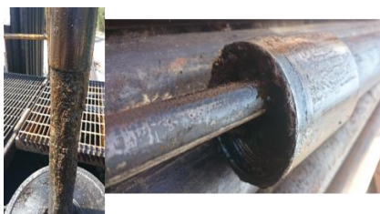
Figura 5. Evidencia de escamas inorgánicas (Izquierda) y parafinas (Derecha) en el pozo WEST B
