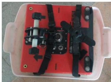
Ilustración 15: Antena de 400 MHz.
