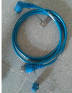
Ilustración 13. Cable de control antena 400 MHz.
