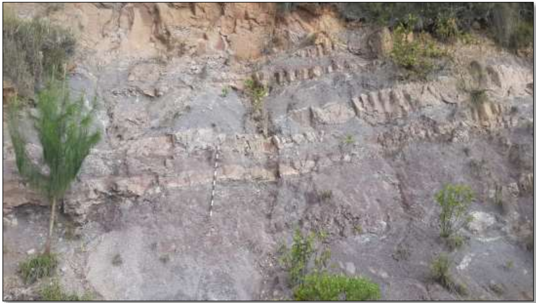
Figura 34. Segmento cuatro. Lodolitas y areniscas azul grisáceo. Km 5 + 400 Vía Santa Rosa de Viterbo – Tobasía.
