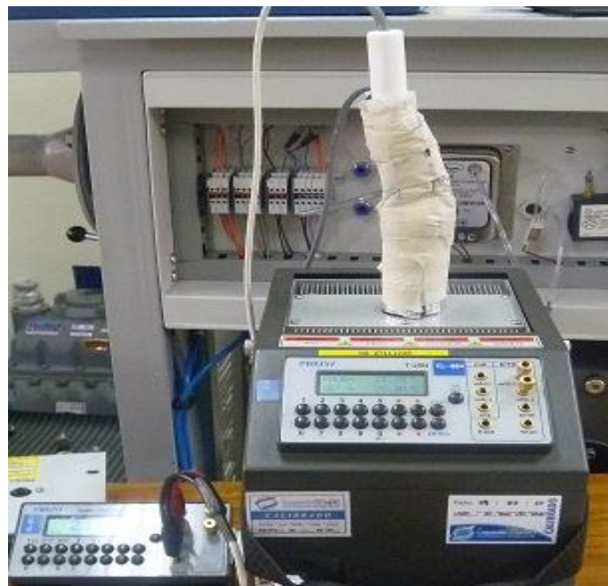
Figura 37. Montaje utilizado para la calibración de las RTDs. Fuente: CDT de GAS.
