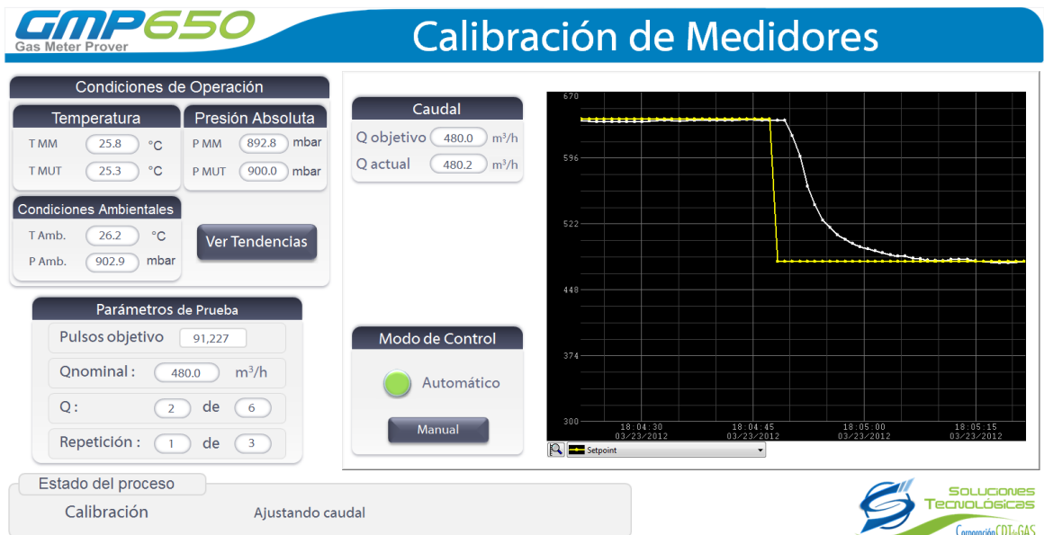
Figura 35. Ajuste de caudal. Fuente: CDT de GAS.
