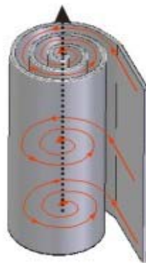
Flujo Tangencial-Radial-Axial Posición Vertical del Intercambiador
