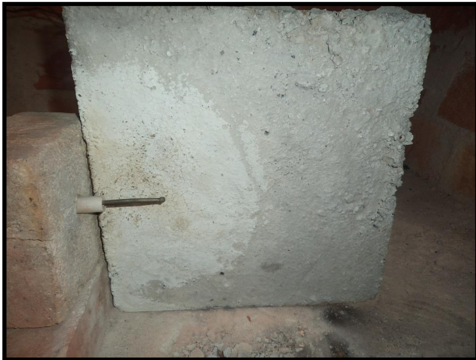
Figura 20. Recubrimiento despues del fuego a base de escoria
