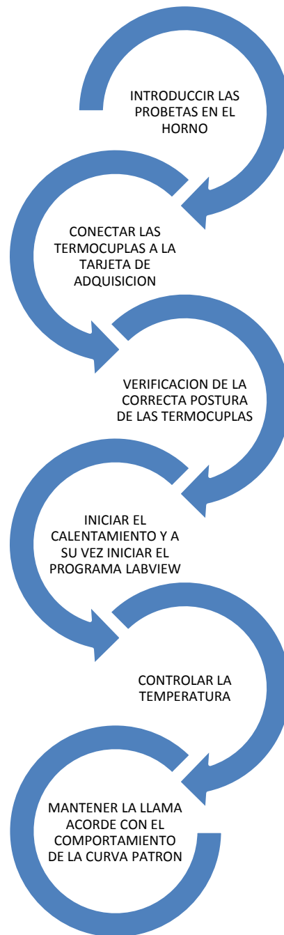
Figura 15. Procedimiento para la exposición ante el fuego de las probetas
