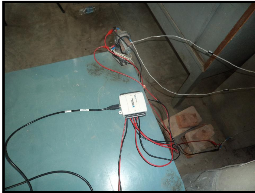
Figura 11. Termocuplas conectadas a la tarjeta de adquisición.
