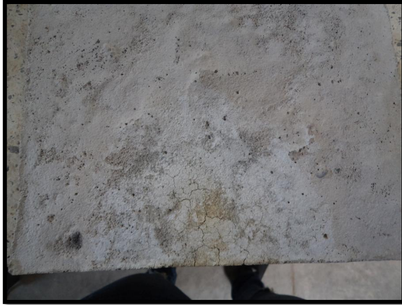
Figura 19. Recubrimiento despues del fuego a base de perlita y escoria
