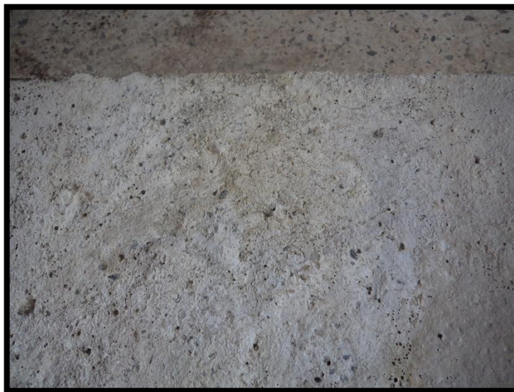
Figura 18. Recubrimiento despues del fuego a base de perlita
