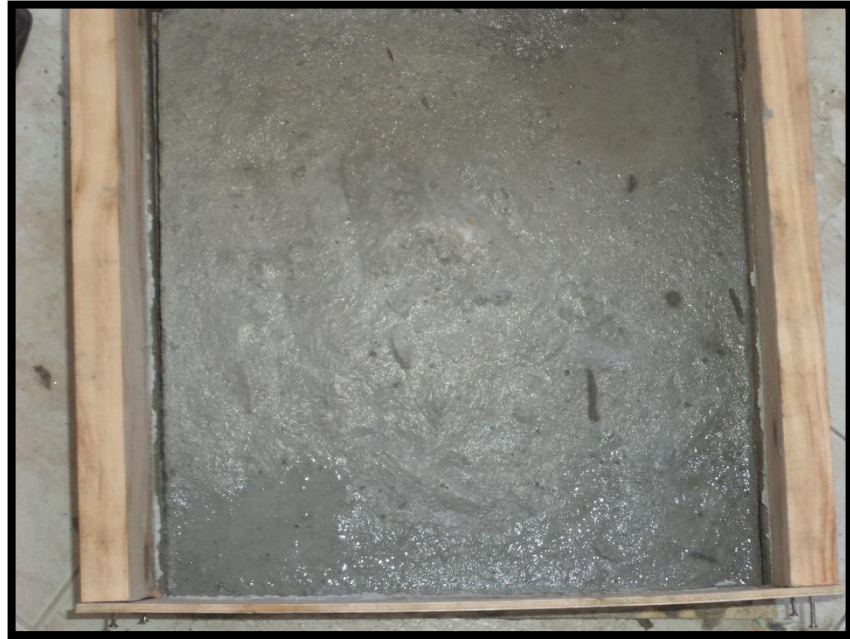
Figura 14. Mortero en el molde
