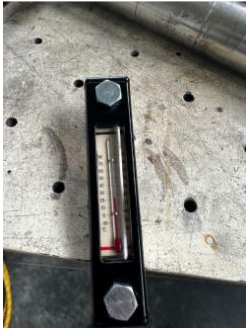
Figura 32. Antiguo visor de aceite con nivel de temperatura
