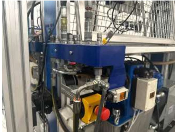
Figura 28. Platina con final de carrera mecánico para encendido del LED
