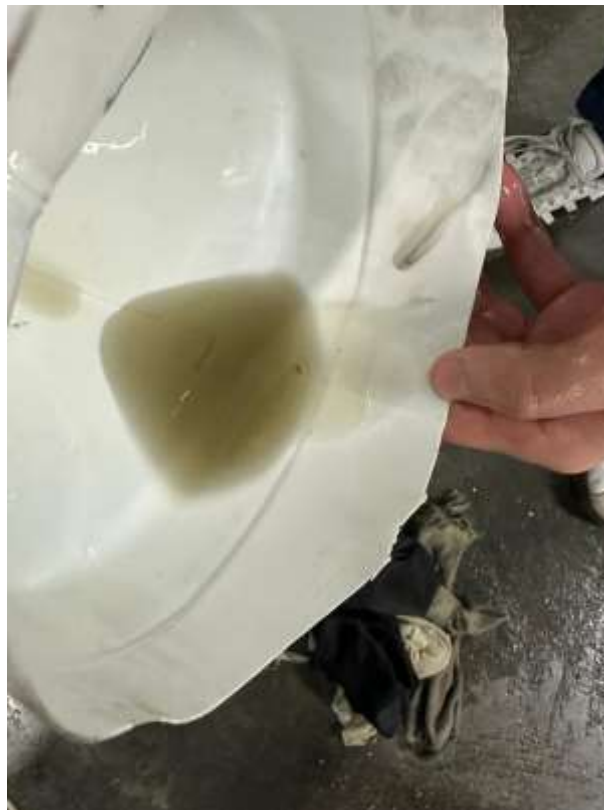
Figura 11. Estado del aceite del banco antes de ser cambiado
