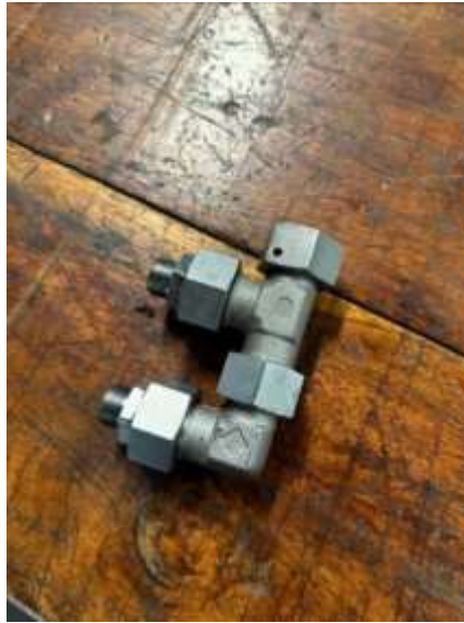
Figura 31. Antigua conexión de entrada al filtro del tanque
