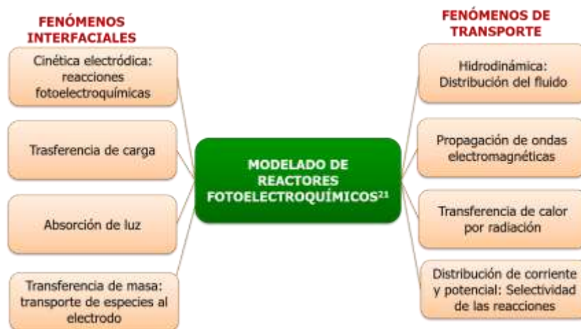
Figura 4. Fenómenos físicos acoplados en un proceso fotoelectrocatalítico. Adaptado de Rivera FF, Cruz-díaz MR, Rivero EP, González I. Elementos de análisis de reactores electroquímicos para su diseño y caracterización. En Barrera C. (Ed.), Aplicaciones Electroquímicas al Tratamiento de Aguas Residuales. Reverté, España (2014) (Rivera et al. 2014).
