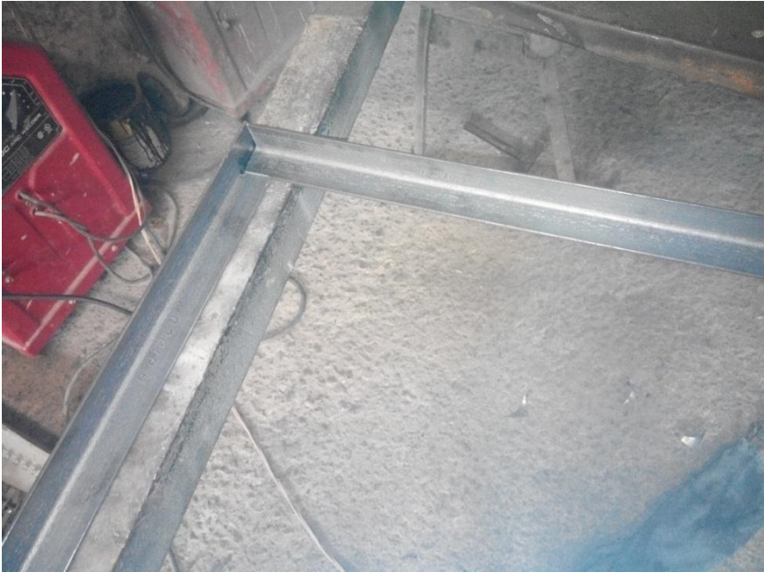
Figura 57. Unión ángulos a 90°
