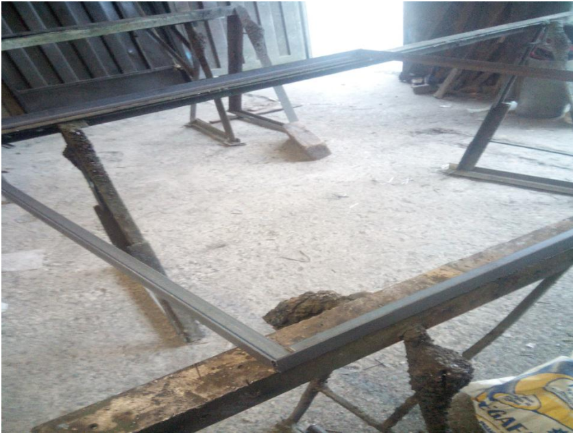
Figura 58. Ángulos unidos con soldadura
