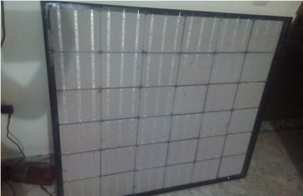
Figura 61. Ensamble ángulo, celdas y vidrio templado
