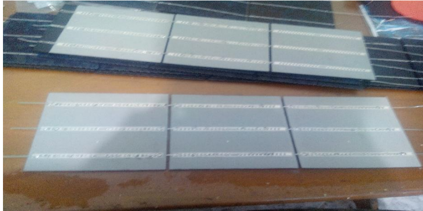
Figura 55. Parte trasera de la unión de tres celdas en serie
