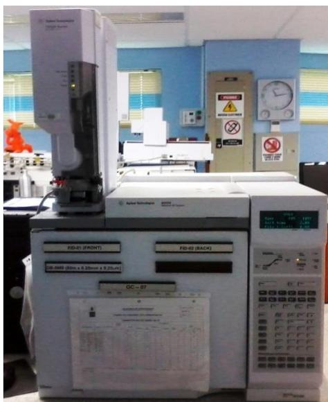
**Figura 19.** Cromatógrafo de gases *Agilent Technologies 6890A Network GC System*. Fotografía tomada por la autora. Lugar: Laboratorio de Instrumentación Analítica, CENIVAM, UIS. Fecha: junio de 2012.
