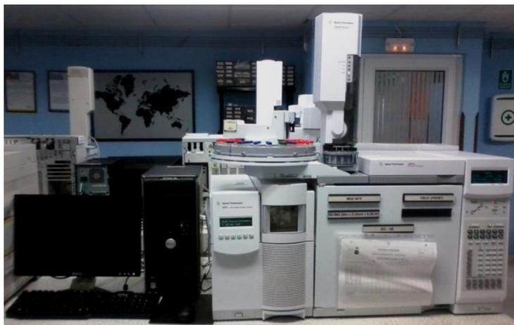
**Figura 17.** Cromatógrafo de gases *Agilent Technologies 6890N Network GC System*. Fotografía tomada por la autora. Lugar: Laboratorio de Instrumentación Analítica, CENIVAM, UIS. Fecha: junio de 2012.
