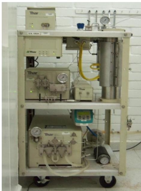
**Figura 16.** Equipo de extracción con fluido supercrítico *Thar SFE-2000*. Fotografía tomada por la autora. Lugar: CENIVAM, UIS. Fecha: octubre de 2012.
