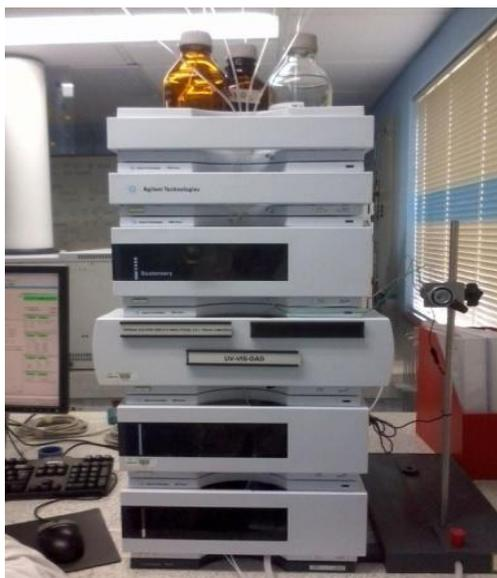
**Figura 20.** Cromatógrafo líquido de alta eficiencia *Agilent 1200 Series*. Fotografía tomada por la autora. Lugar: Laboratorio de Instrumentación Analítica, CENIVAM, UIS. Fecha: junio de 2012.
