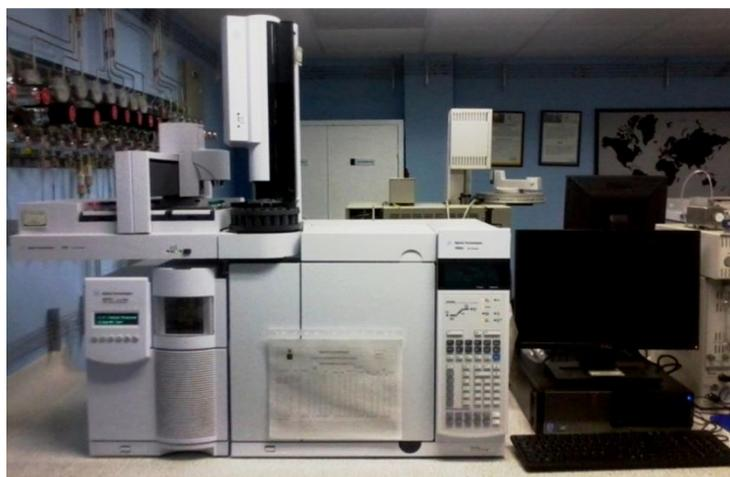
**Figura 18.** Cromatógrafo de gases *Agilent Technologies 7890A GC System*. Fotografía tomada por La autora. Lugar: Laboratorio de Instrumentación Analítica, CENIVM, UIS. Fecha: junio de 2012.
