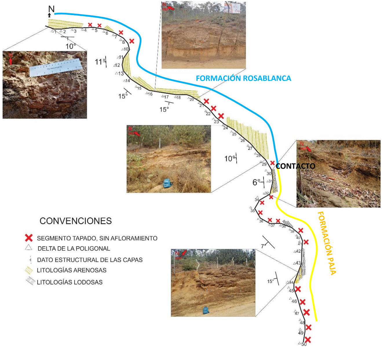
Fig. 16 Poligonal abierta de la sección Galán
