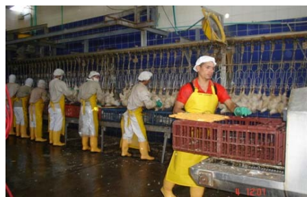
Arrastre de guacales a la banda transportadora, para posteriormente abrir el guacal, sacar el animal y colgarlo en los ganchos de la cadena transportadora.
