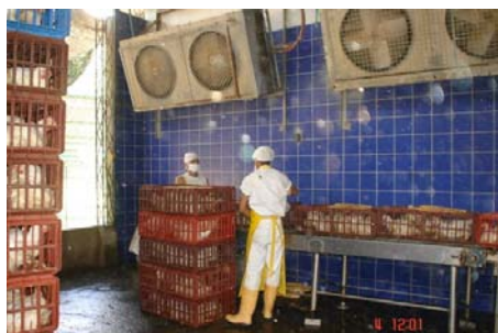
Arrastre de guacales a la banda transportadora, para posteriormente abrir el guacal, sacar el animal y colgarlo en los ganchos de la cadena transportadora.
