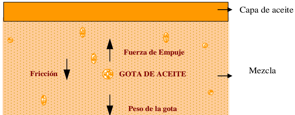
Figura 15. Fuerzas que actúan sobre las gotas de aceite para su clarificación
