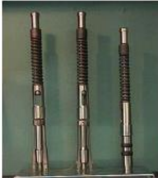
Figura 9: Set (derecha a izquierda): Tubing Stop, Collar Stop, Copa de asiento.
