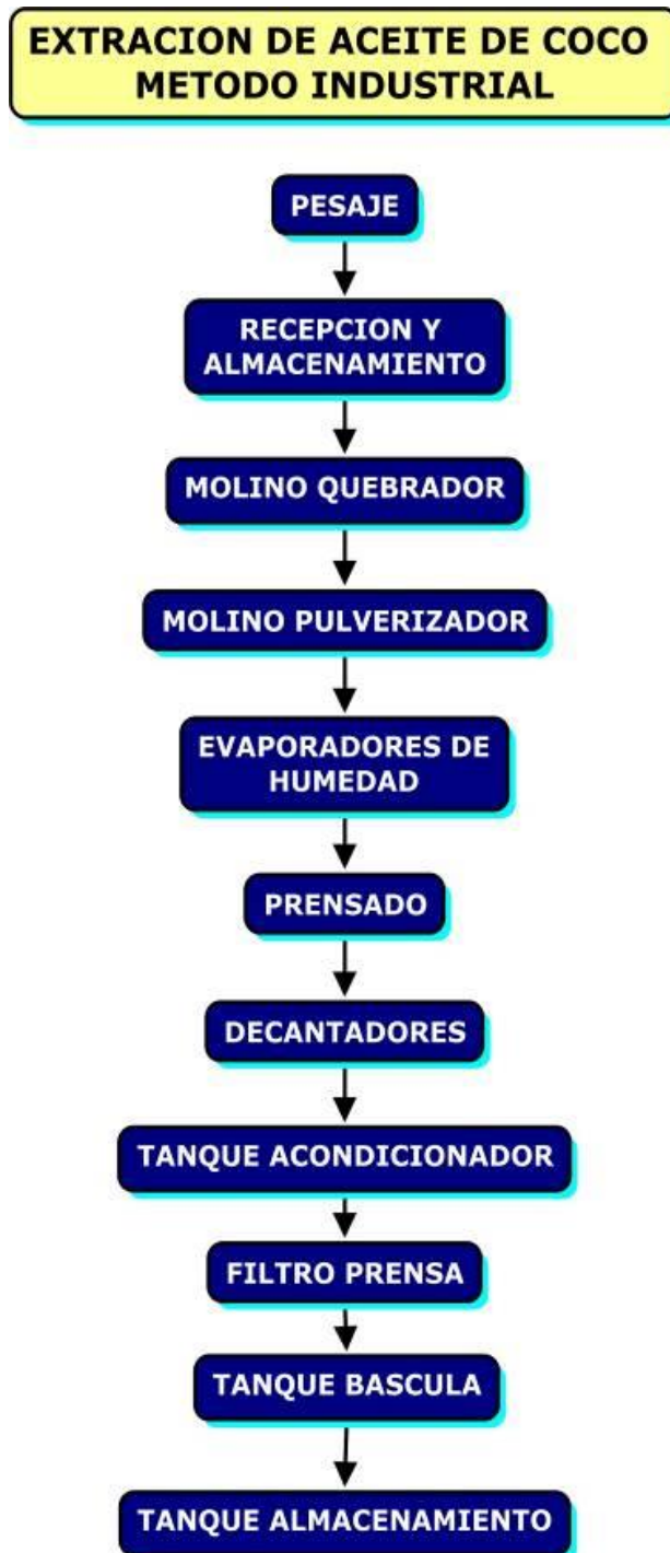
Figura 4: Flujograma del proceso de extracción del aceite de coco de manera industrial.
