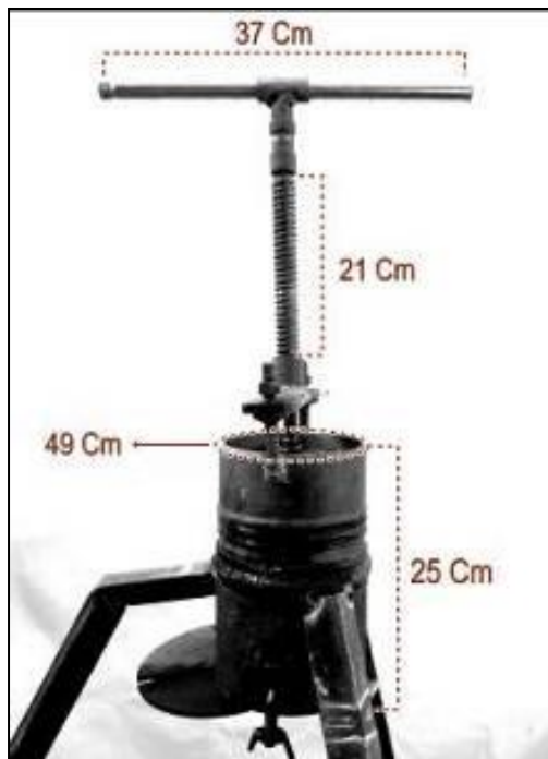
Figura 13: Dimensiones del cilindro y palanca de la prensa artesanal.
