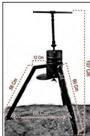
Figura 12: Dimensiones de la prensa artesanal.
