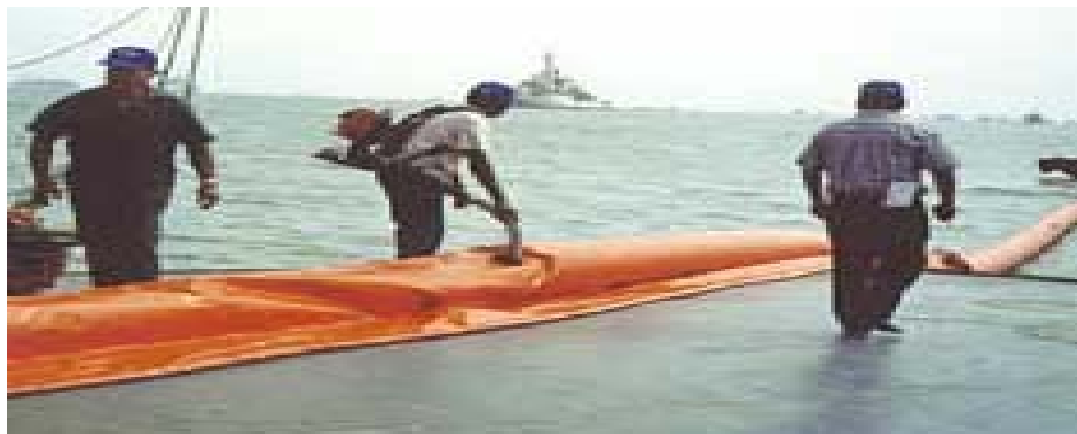
Figura 22. Despliegue de barrera en el mar, inflada con ventilador portátil
