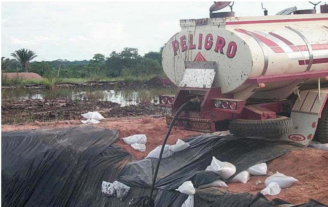
Foto 39. Carro tanque descargando crudo hacia las piscinas
