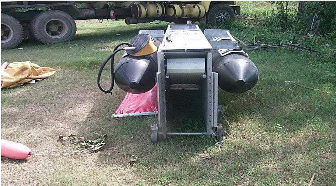
Foto 38. Skimmer de plano inclinado Referencia Desmi
