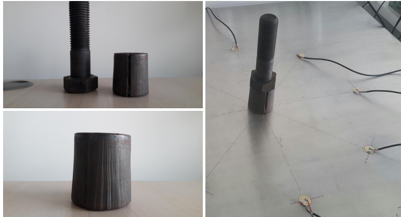
Figura 2.3: Izquierda: masas usadas par simulación de daños con un peso de 1kg cada una. Derecha: Masas ubicadas sobre la lamina de aluminio.
