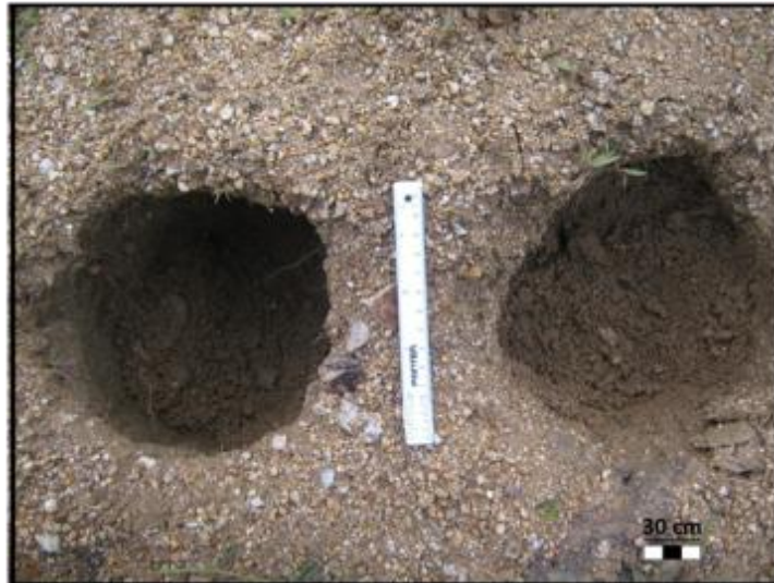
Figura 14. Apique realizado sobre la vía Curoso-Málaga.
