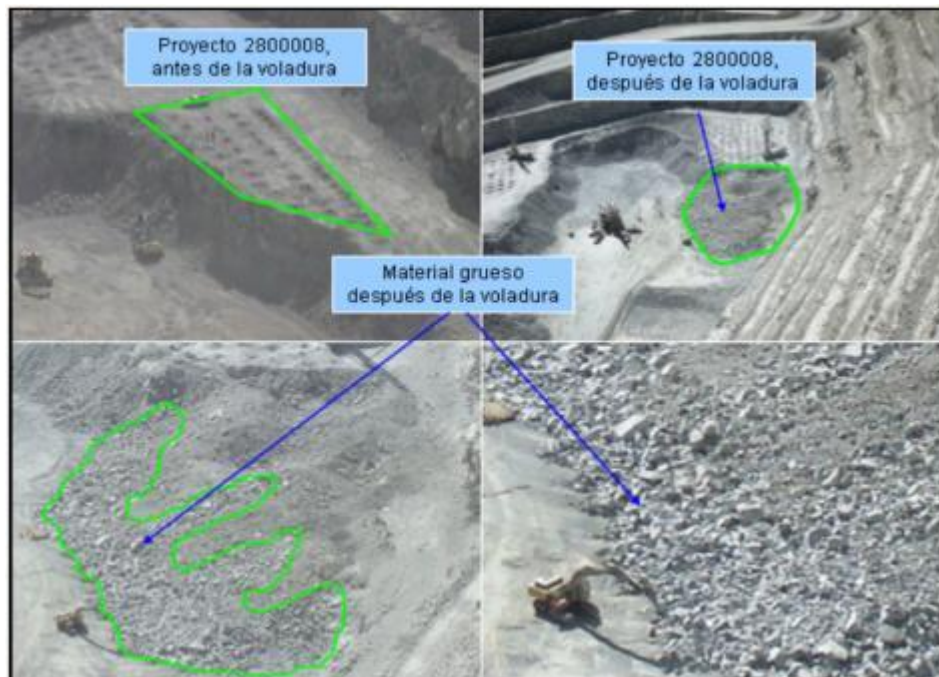
Figura 6. Fragmentación de una voladura convencional (Mina Toquepala)
