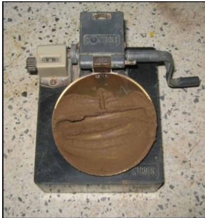
Figura 17. Ensayo de límite líquido en cuchara de Casagrande.
