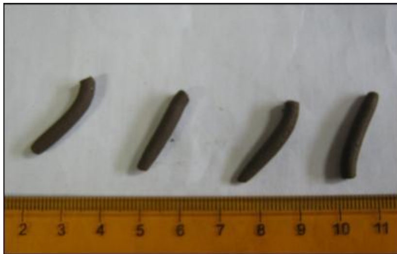
Figura 16. Elaboración de los cilindros de suelo para el límite plástico.
