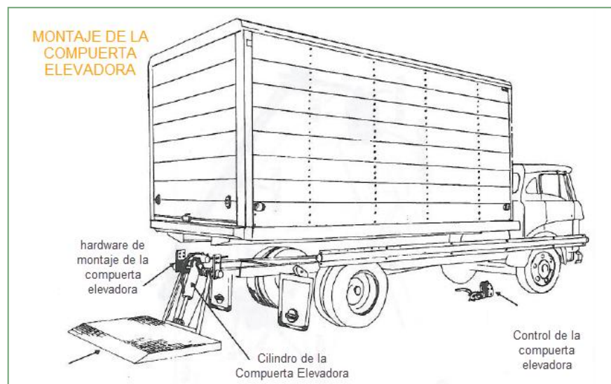
Figura 34. Montaje de la compuerta elevadora
