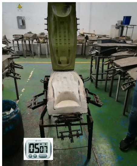
Figura 68. Diseño inicial del timer en los moldes de espuma.
