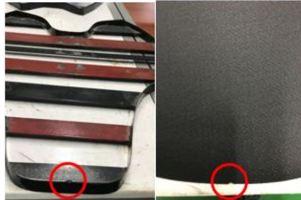
Figura 69. Acción de los puntos céntricos en las piezas.
