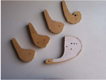
Levas diseñadas para la prensa. Conjunto de prensa, mordazas, leva y resorte.
