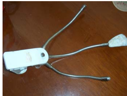
Carcasa con el circuito electrónico montado. Modelo experimental del mouse adaptable.
