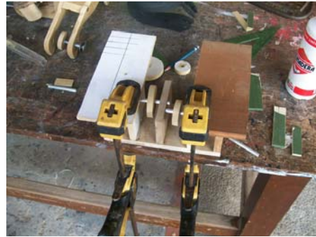
Carcasas con los botones y esferas montadas. Prensado de piezas.
