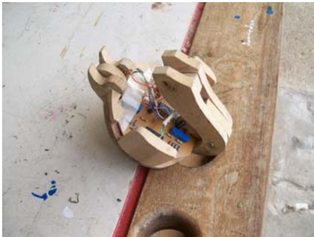
Carcasa con el circuito electrónico montado. Modelo experimental del mouse adaptable.
