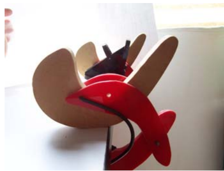
Levas diseñadas para la prensa. Conjunto de prensa, mordazas, leva y resorte.
