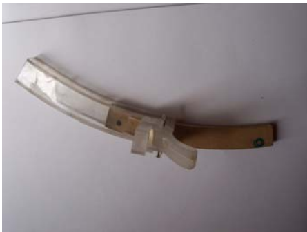
Sistema de extensión o de alcance, corredera y leva de presión para sujeción.
