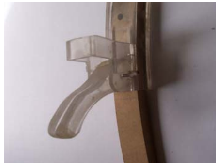
Sistema de extensión o de alcance, corredera y leva de presión para sujeción.
