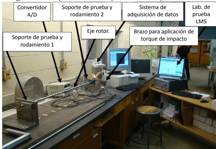
Figura 22.15 Disposición del banco para detección de fisuras en rotores.
