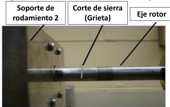
Figura 22.16 Corte con sierra para simular la grieta.
