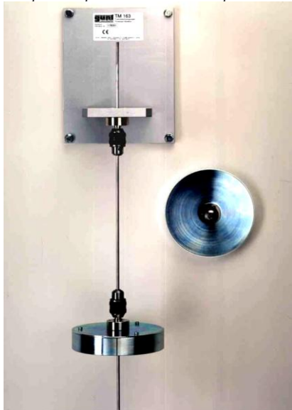
Figura 22.8 Modelo físico del Aparato péndulo torsional para mediciones de vibración TM 163
