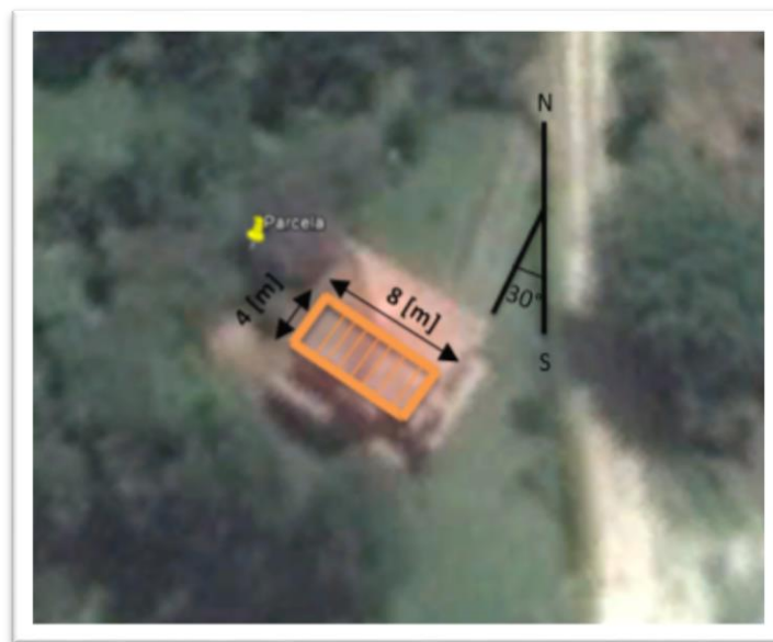
Figura 48. Orientación de los módulos solares
