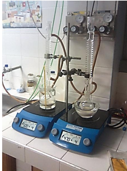
Figura 5. Reactores en serie equipados con reflujo y agitación magnética.
