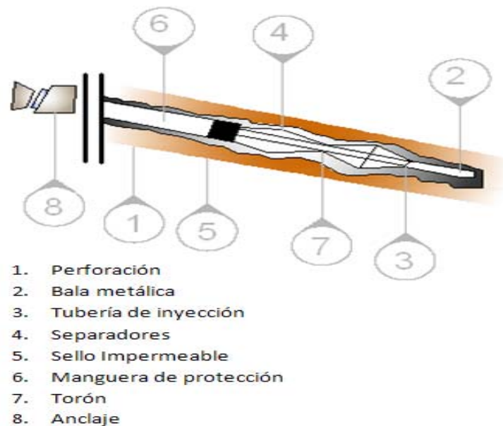
Figura 106 Parte para instalación de un anclaje
