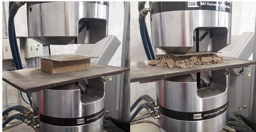
Figura 23. Ensayo a Compresión Simple de LC y LF.
