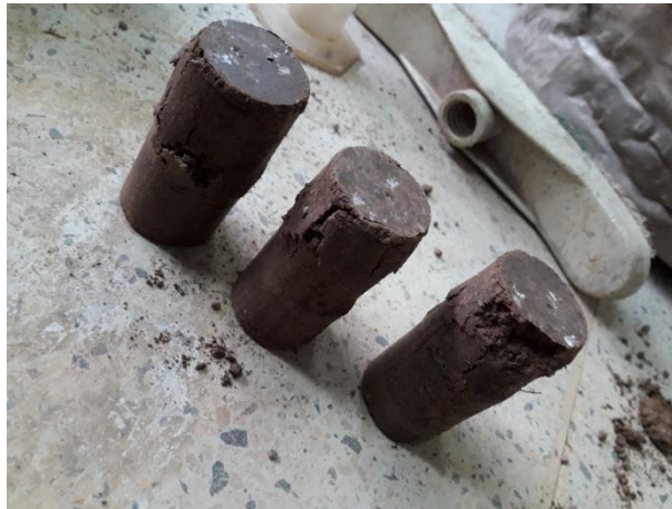
Figura 15. Cilindros de muestra de suelo antes del Ensayo de Compresión Simple.
