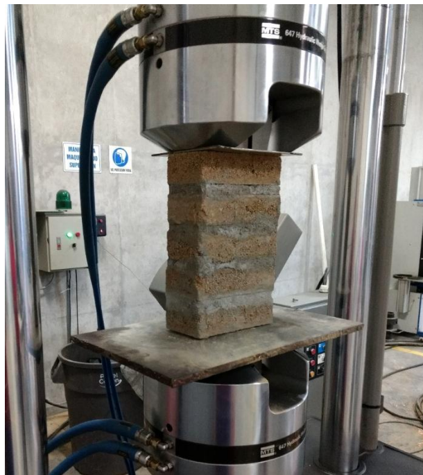
Figura 26. Ensayo a Compresión Simple de Muretes.
