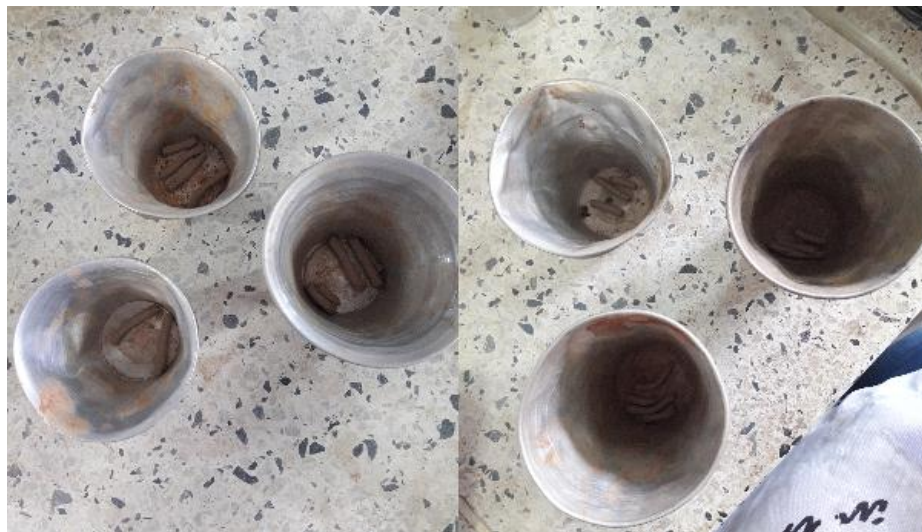
Figura 8. Muestras obtenidas del Ensayo de Límite Plástico.
