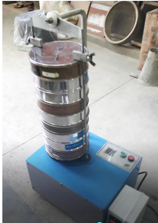
Figura 5. Tamizado Mecánico para Ensayo Granulométrico.
