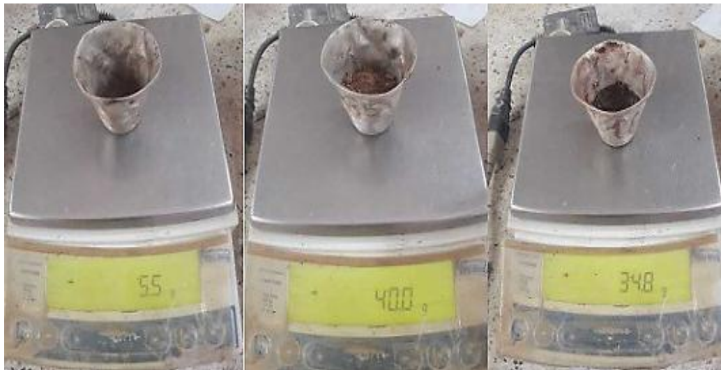
Figura 19. Medición de la humedad natural del suelo después de la extracción. (Peso de la Tara, Peso Suelo Húmedo y Peso Suelo Seco respectivamente).
