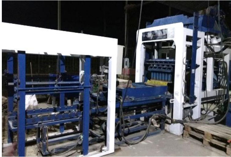
Figura 20. Maquina empleada en la elaboración de los ladrillos de suelo-cemento.
