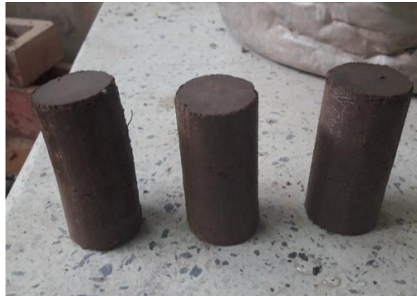
Figura 13. Cilindros de muestra de suelo antes del Ensayo de Compresión Simple.
