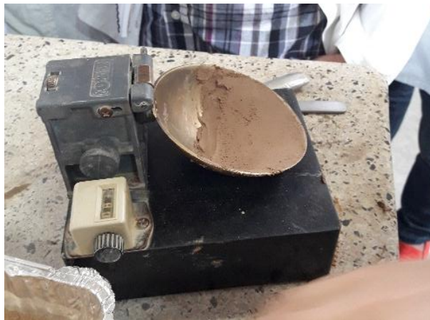
Figura 6. Ensayo de Casagrande para el cálculo de Límite Líquido.
