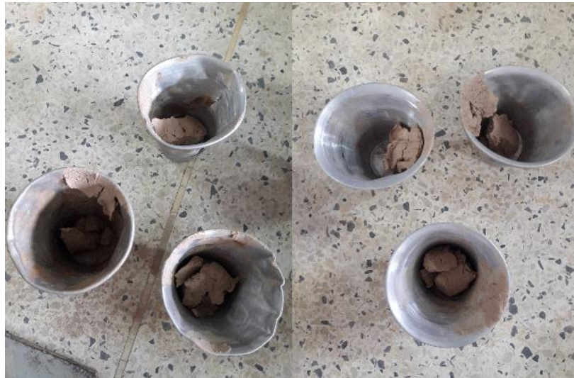
Figura 7. Muestras obtenidas del Ensayo de Casagrande.
