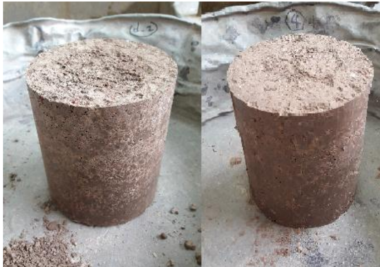
Figura 10. Muestras obtenidas del Ensayo de Próctor Estándar.
