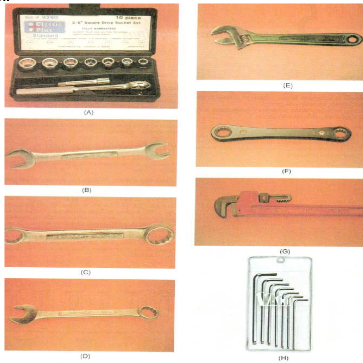
Figura 45. (A) Juego de copas con rache. (B) Llave de boca fija. (C) Llave estrella. (D) Llave mixta. (E) Llave expansiva. (F) Llave con trique. (G) Llave para tubos F. (H) Llaves Bristol.
