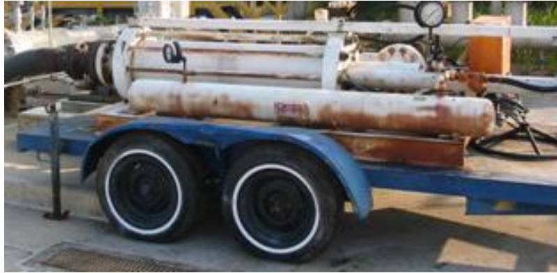
Figura 19. Probador portátil para calibrar los medidores en Casabombas 7
