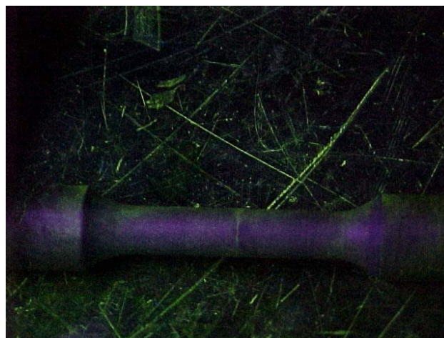
Figura 43. Identificación de la falta de fusión con partículas magnéticas fluorescentes
