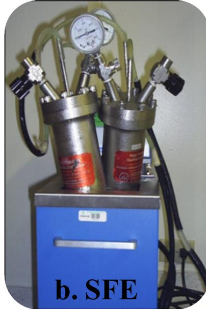
Montajes empleados para la obtención de los extractos de las plantas por (a). destilación-extracción simultánea con solvente y (b). extracción con fluido supercrítico.
