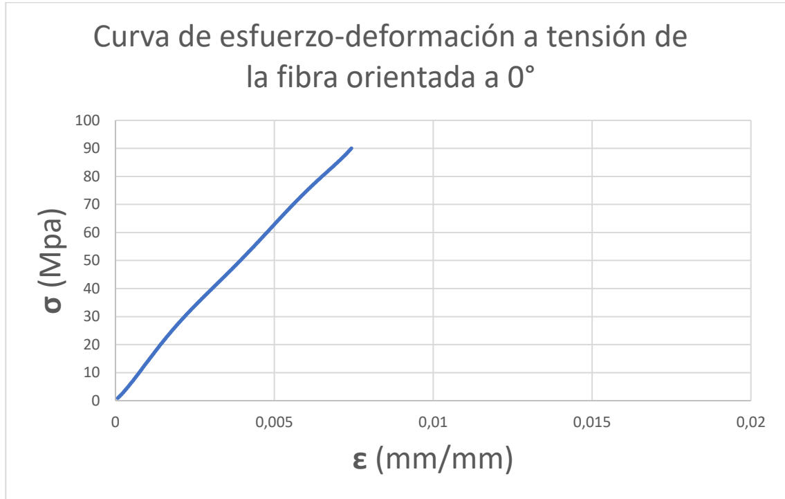
Figura 3. Grafica esfuerzo-deformación a tensión de la fibra orientada a 0°.
