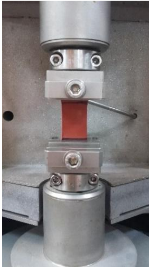
Figura 18. Montaje de las probetas en las mordazas.
