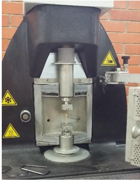
Figura 13. Cámara para ejecución de ensayos-maquina DMA.
