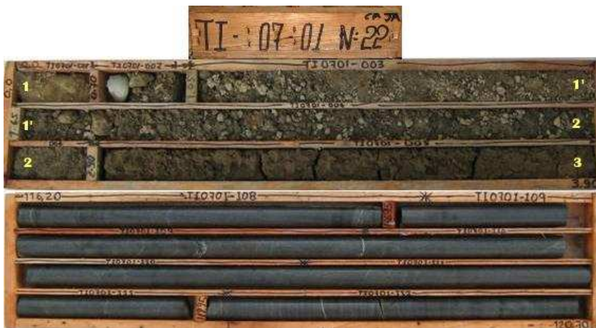
Imagen 24. Características generales de las cajas; marcado, colocación del testigo sobre la caja, tacos con profundidad avanzada. Las cajas se marcan con el número del pozo de perforación y la secuencia del número de caja y el testigo en la caja debe colocarse de 1 a 1', 1' a 2 y de 2 a 3.
