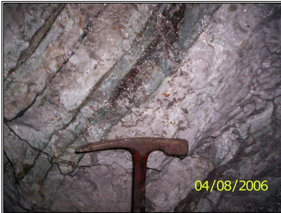
Imagen 2. Secuencia estratificada y laminada de roca cuarzosa ligeramente calcárea. Sulfuros Diseminados y concentrados a lo largo de la laminación. Mineralización selectiva según Composición del protolito original. Zona de Skarn. Localidad: Cruzada Oscar Darío Arango. FR-315
