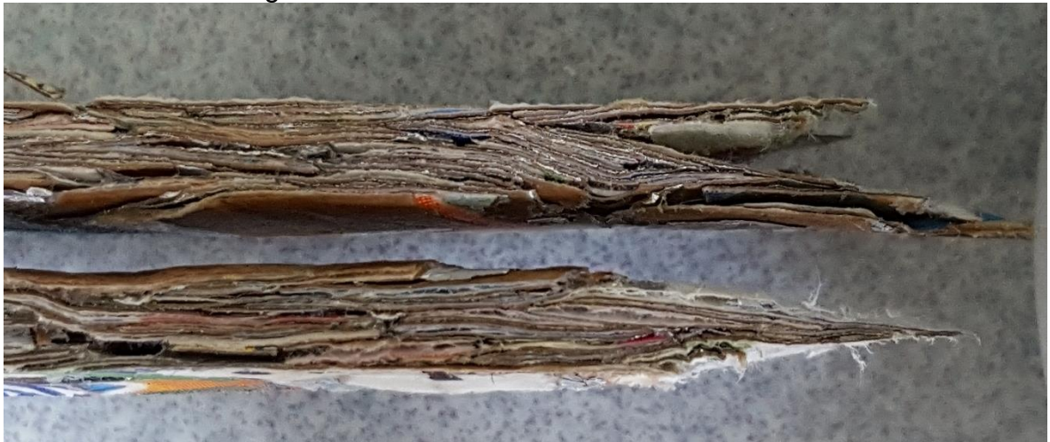
Figura 26. Deslizamiento de fibras a tracción.
