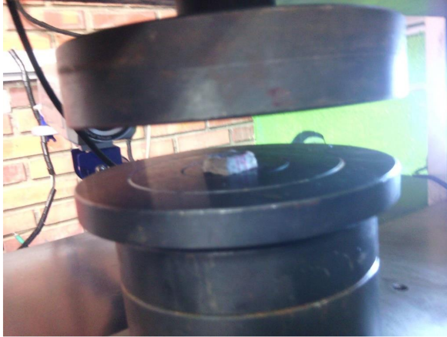
Figura 13. Montaje de la probeta en máquina universal de ensayo.
