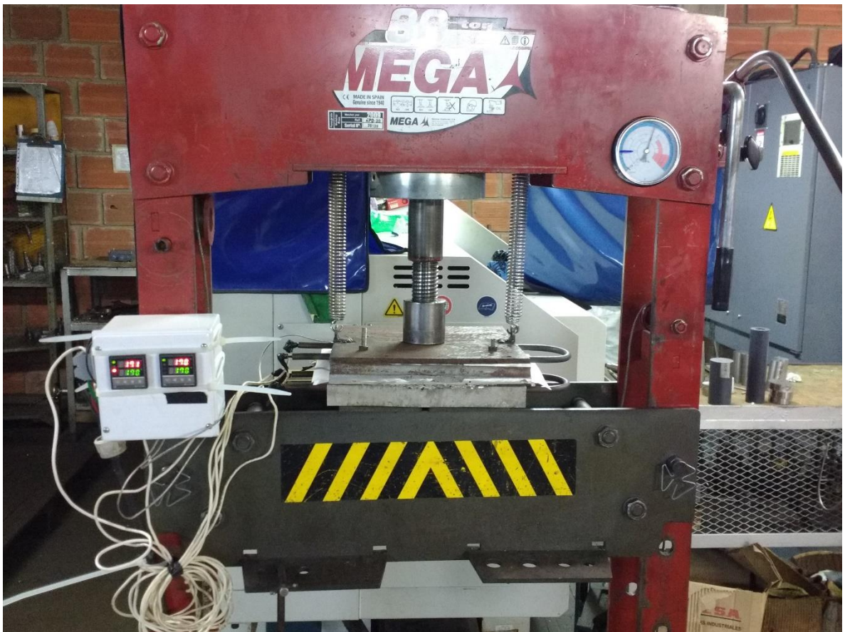
Figura 6. Prensa MEGA KPD-30 modificada con control de presión y temperatura.
