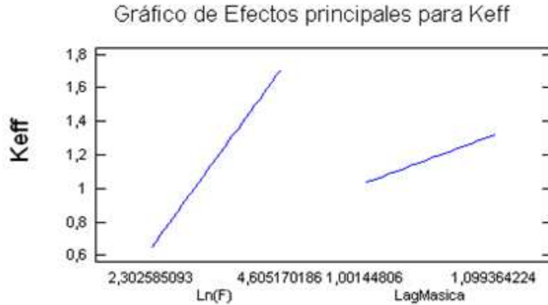
Figura D.2. Gráfico de efectos principales de las variables experimentales sobre la conductividad efectiva, aplicable a F_{sol/fluido} menores a 100
