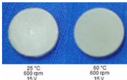
Figura 31. Efecto de la temperatura en la uniformidad del recubrimiento
