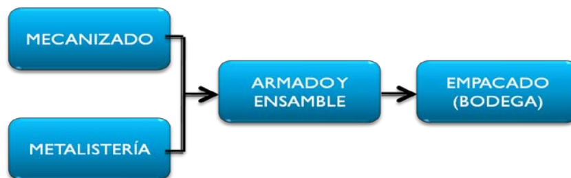
Ilustración 4. Diagrama de flujo del producto por secciones.
