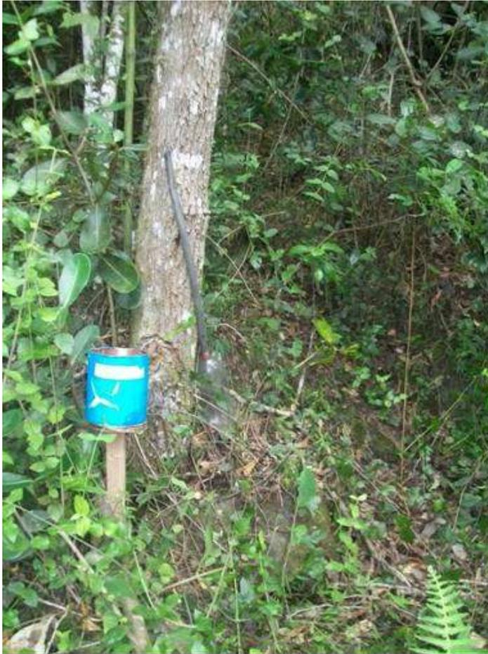
Para la medición de la interceptación se utilizó una probeta de 10mm utilizada en las estaciones meteorológicas; se tuvieron que elaborar unas probetas construidas a escala para la respectiva toma de datos.
