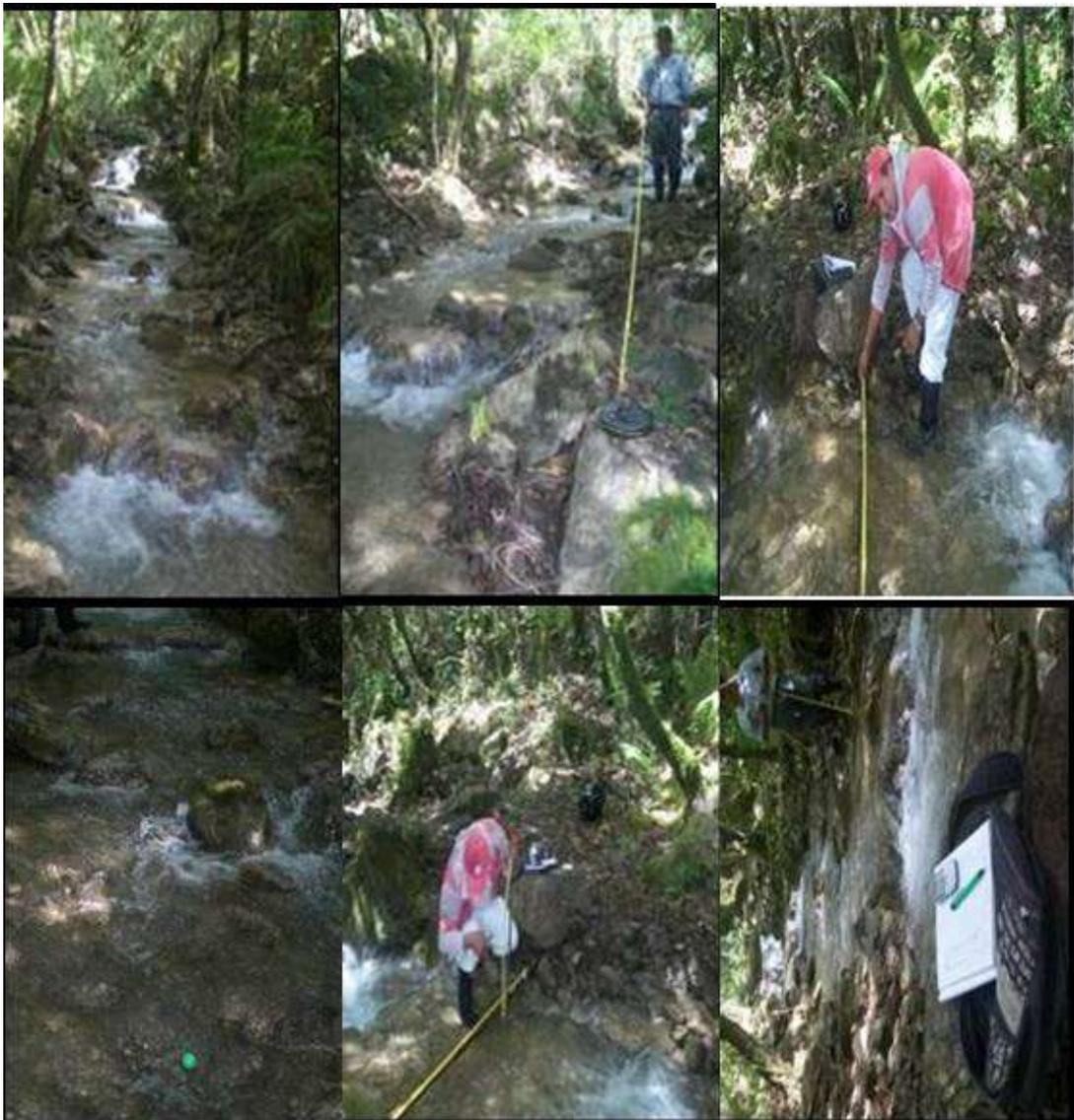
Para la determinación de la velocidades se tomó el tiempo en que tardaba el flotador (pin pon) en llegar desde el punto de inicio hasta un punto final a una distancia determinada, se repitió este procedimiento varias veces para descartar datos erróneos.
