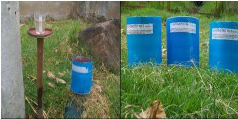
**Figura 7. Toma de datos para cálculo de la precipitación**
