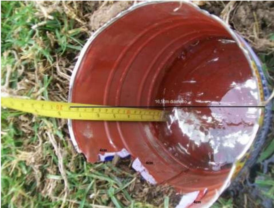
Las pruebas de infiltración se realizaron en un período de precipitación constante, implementando el infiltrómetro de regadera, donde se aplicó un rocío a una velocidad determinada mayor que la capacidad de infiltración. La capacidad de infiltración de la unidad hidrológica El Tejar se obtuvo siguiendo la siguiente fórmula:
