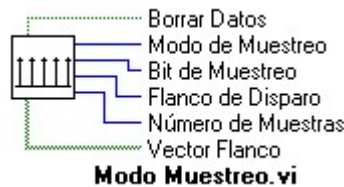
Figura 31 Diagrama de Conexiones del Sub-VI Modo Muestreo
