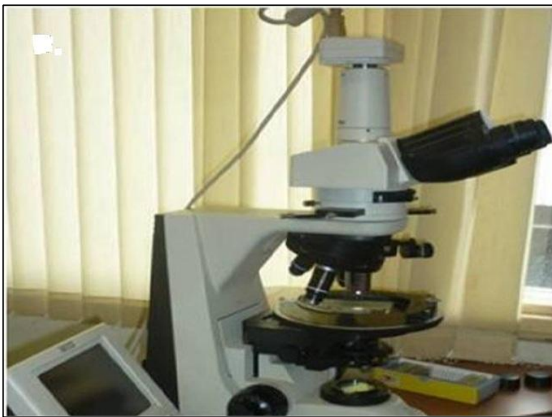
Figura 3. Equipo Utilizado. Microscopio de Luz Transmitida marca NIKON ECLIPSE E200 50/POL con cámara y pantalla incorporada: Digital Sight DS-SM y Digital Sight DS-L1.
