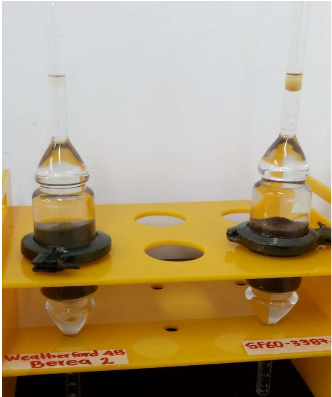
Figura 21. 2° día de desplazamiento espontáneo – celdas de Amott
