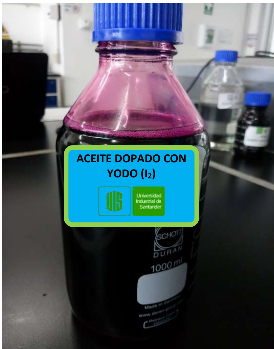
Figura 28. Aceite dopado con yodo ( I_2 ) – máxima concentración.
