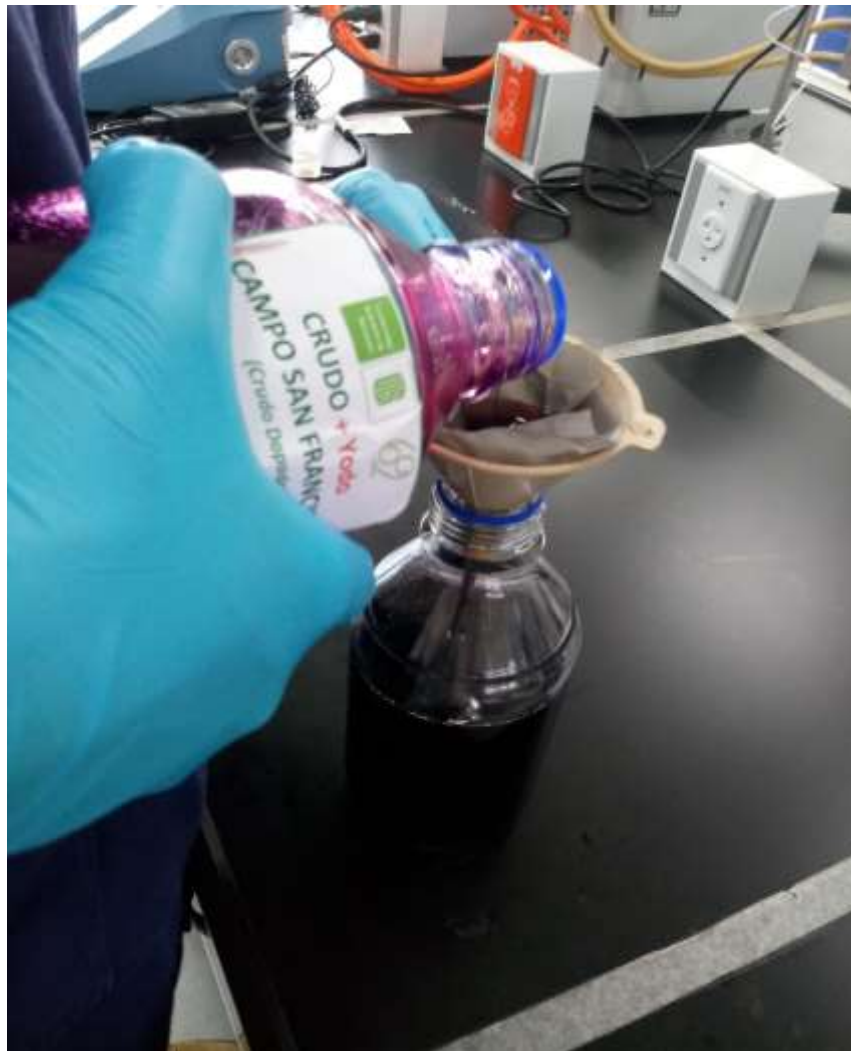
Figura 29. Filtración aceite dopado
