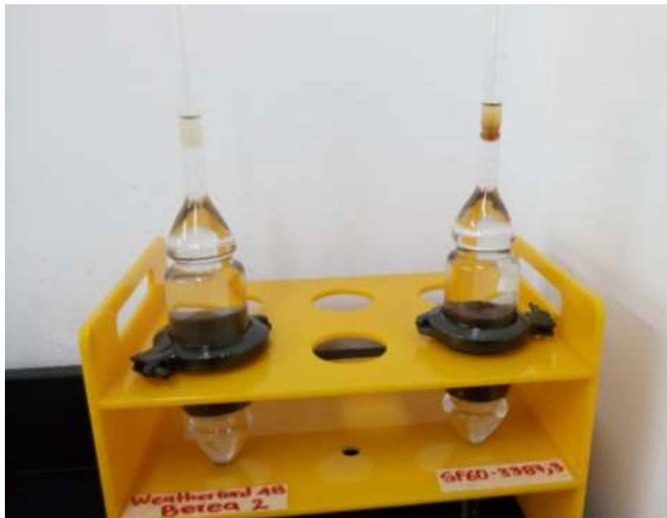
Figura 23. Avance a los 15 días de desplazamiento espontáneo de aceite – celdas de Amott
