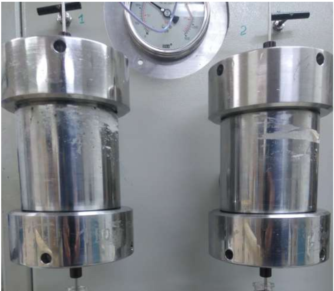
Figura 25. Equipo de desplazamiento forzado – core holder.
