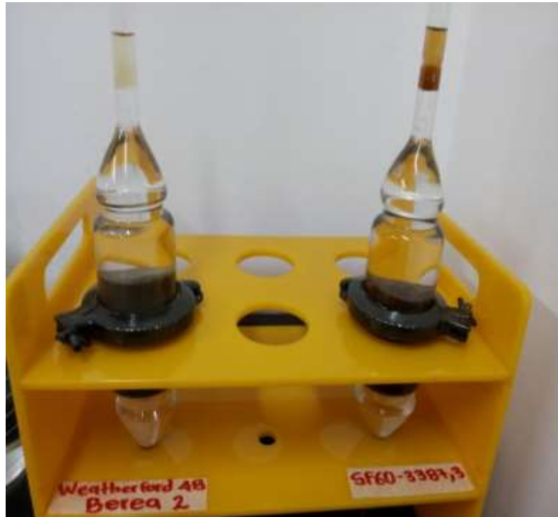
Figura 24. Fin del desplazamiento espontáneo de aceite – celdas de Amott.
