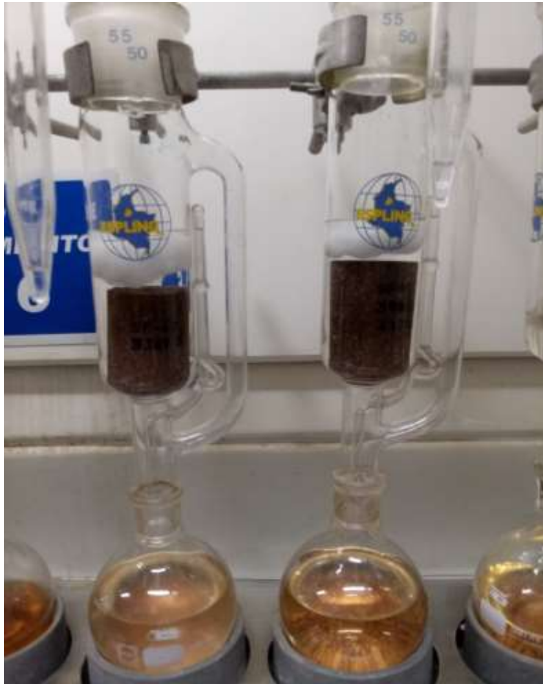
Figura 14. Limpieza muestra de roca Campo San Francisco pozo 60 y muestra Berea.
