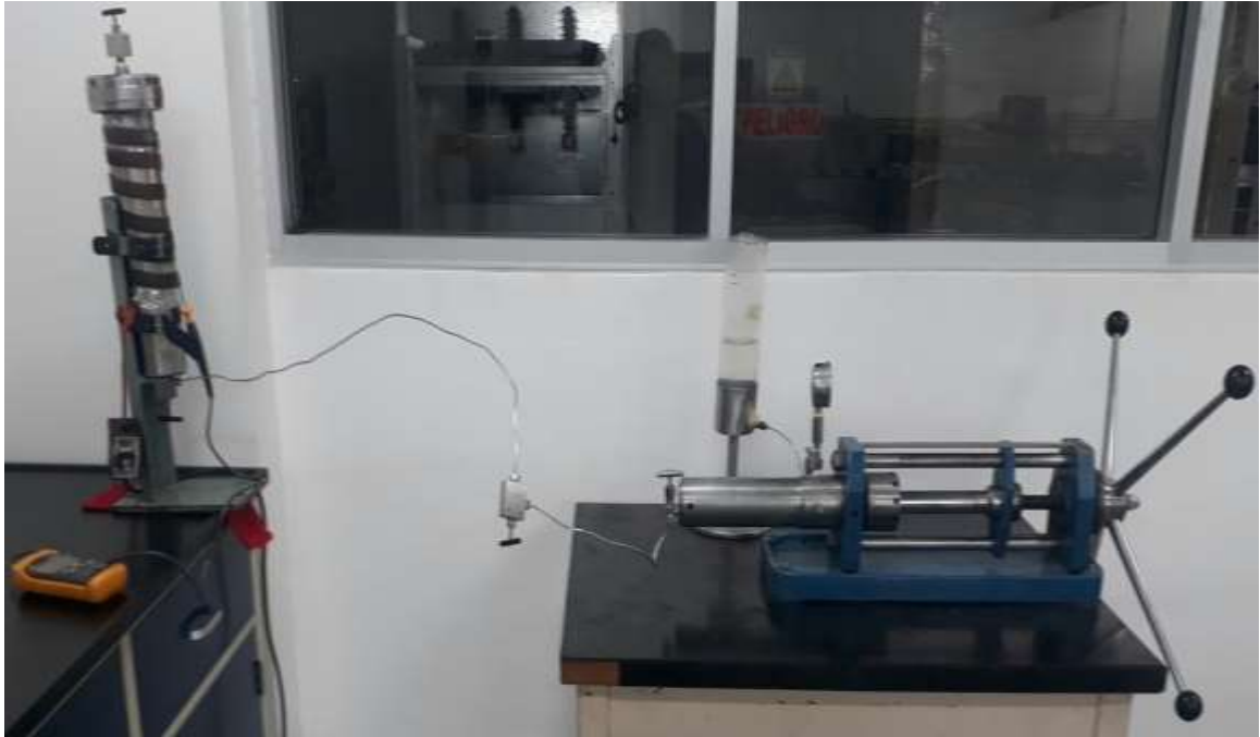
Figura 18. Sistema free piston para restauración de mojabilidad.
