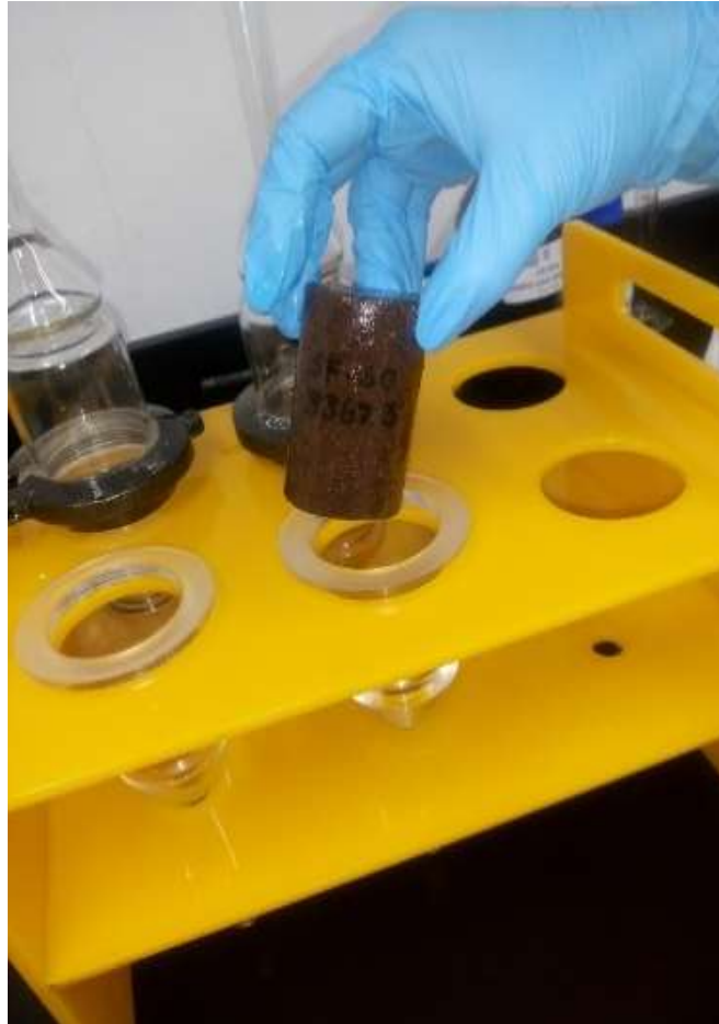
Figura 20. Montaje de muestras en celdas de Amott.
