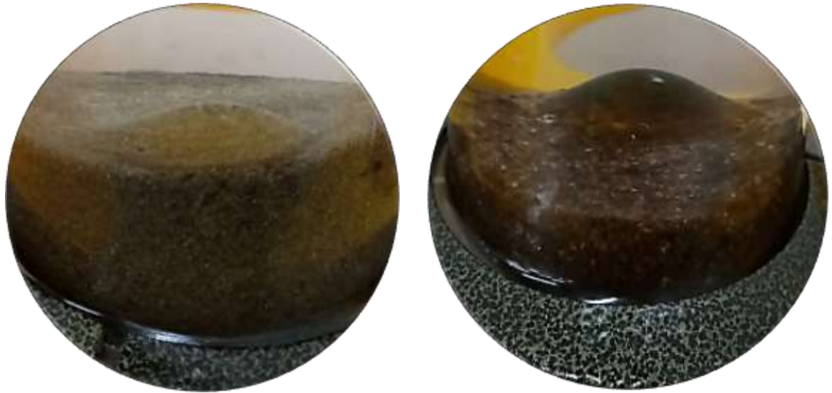
Figura 22. Ampliación desprendimiento de gota de aceite – desplazamiento espontáneo.
