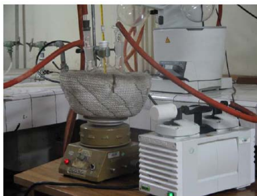
Figura 12. Montaje preparación glucósidos.
