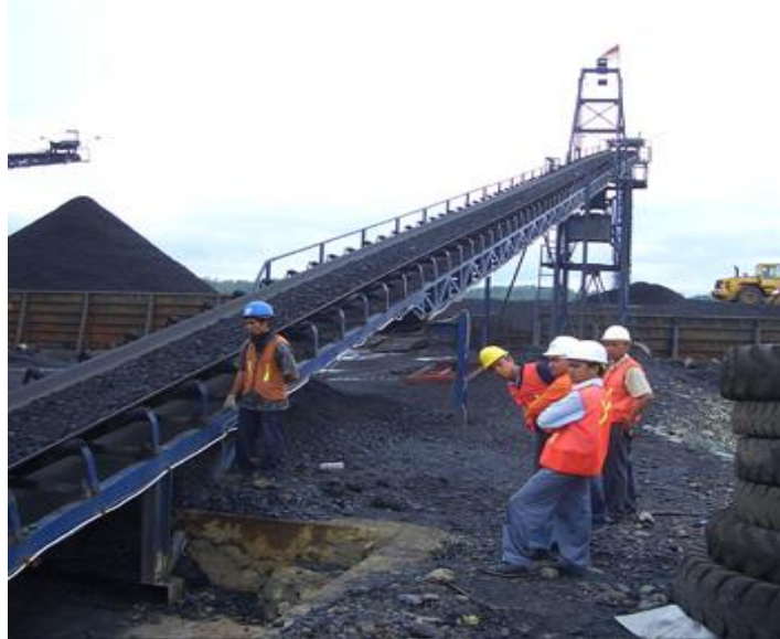
Figura 13. Banda clasificadora de carbón. Centro de Acopio zona Pajarito Bulktrading.
