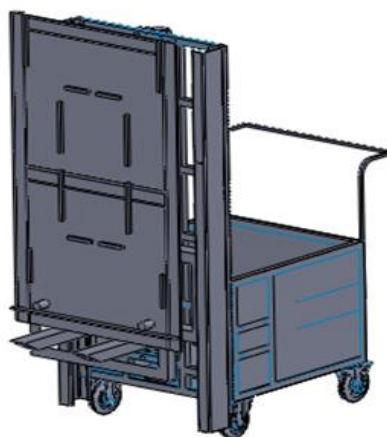
Figura 109. Dispositivo estructura lateral tolva acoplado al vehículo
