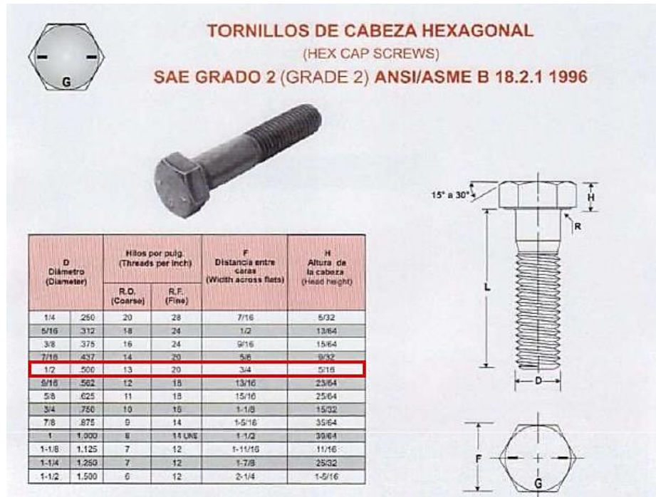
Figura 106. Características geométricas del tornillo SAE GRADO 2
