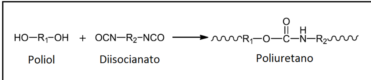
Figura 2. Reacción entre el polioliol y el diisocianato para la obtención de poliuretanos
