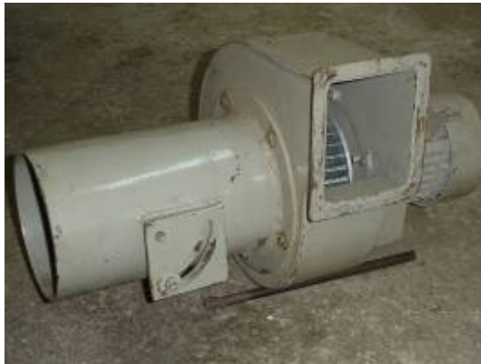
Figura 133 Construcción y montaje del admisor de aire para la hornilla
