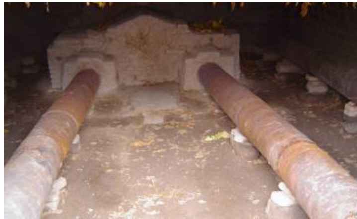
Figura 29 Tubos de intercambio de un horno convencional brasileiro
