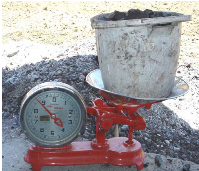
Figura 146 Balanza para determinar el consumo de carbón en el tiempo
