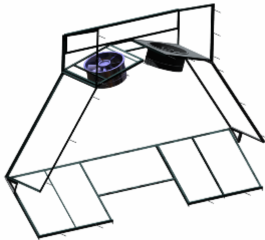
Figura 113 Representación virtual de la estructura del recirculador RHT: a) Solidworks®; b) ANSYS®
