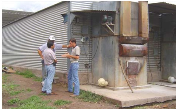
Figura 32 Horno hornilla para un horno de 12 metros tipo Bulk-curing a leña en Argentina
