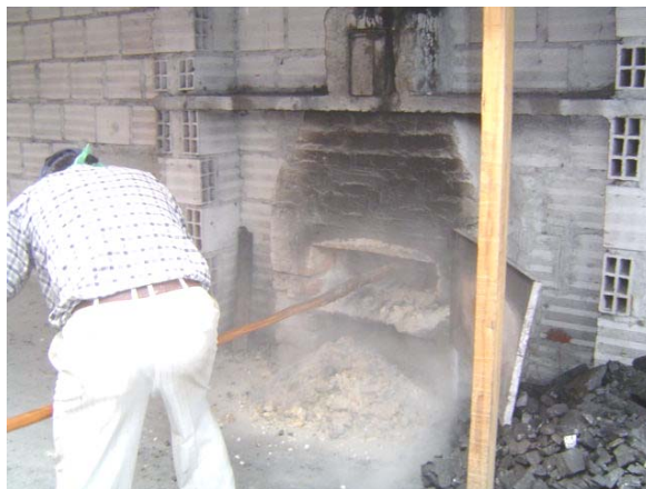
Figura 33 Hornilla convencional de Colombia. Horno de capacidad 2,5 hectáreas
