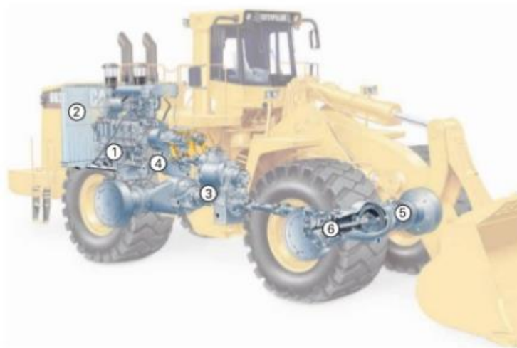
Figura 9. Tren de potencia. Ubicación de componentes.
