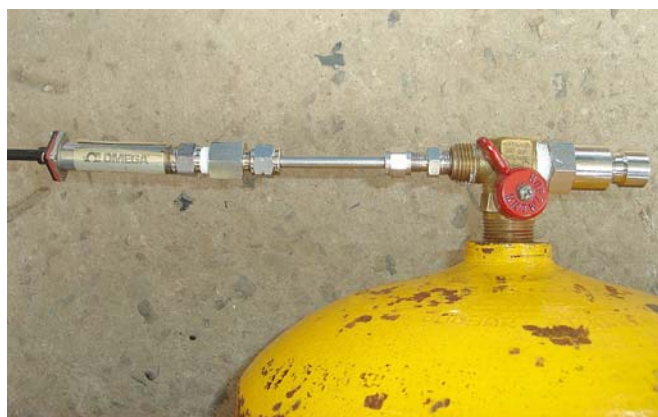
Figura 24. Válvula con sensor de presión y accesorios OD
