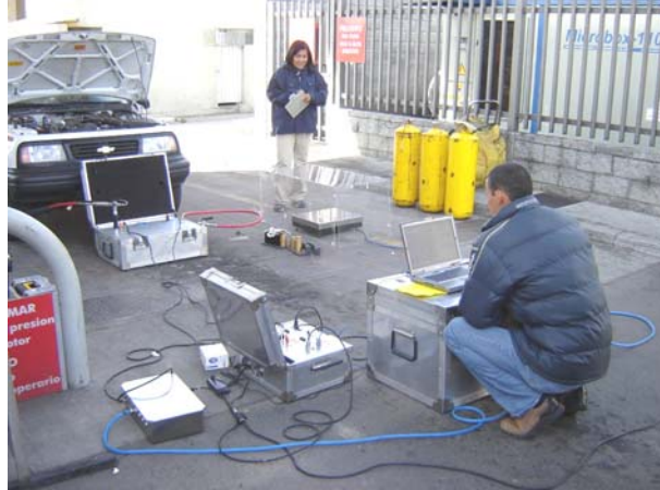
Figura 82. Ajuste del cero del sistema de pesaje
