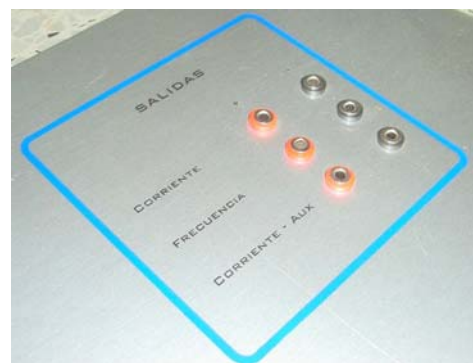
Figura 35. Placa de aluminio para el medidor másico patrón
