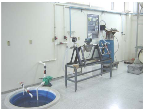
Figura 72. Banco de calibración de medidores máxicos
