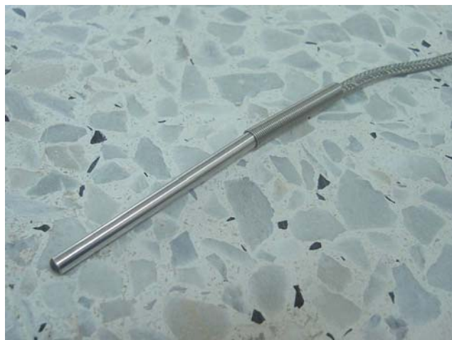
Figura 58. RTD para la temperatura del fluido
