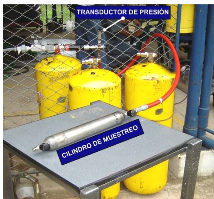
Figura 88. Llenado de la muestra de gas para análisis cromatográfico
