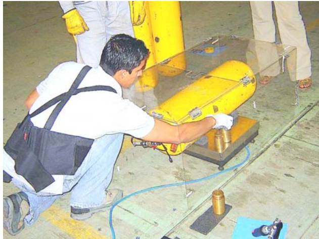
Figura 84. Verificación del sistema de pesaje.
