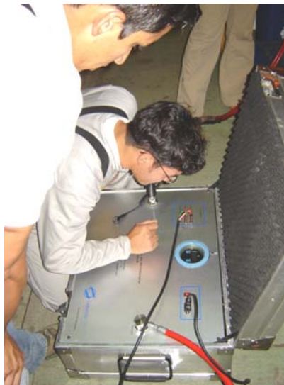
Figura 83. Ajuste del cero del medidor másico de Coriolis
