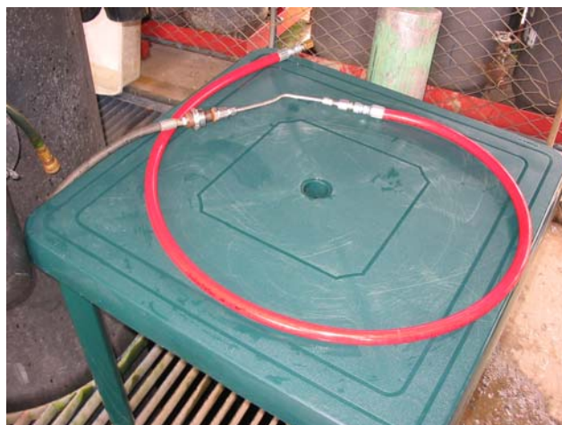
Figura 29. Ensayo a la manguera y sus conectores.
