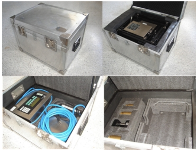
Figura 25. Maleta para la protección del sistema de pesaje.
